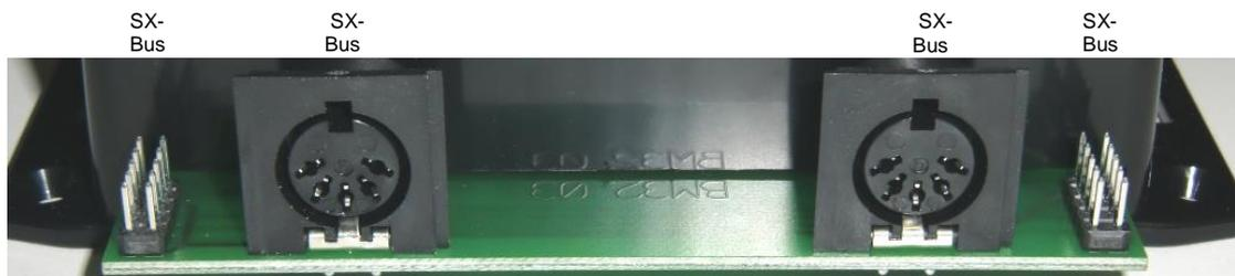
Diese vier Anschlüsse sind intern alle miteinander verbunden und stellen den Ein- und Ausgang des SX-Busses für den Gleis-Belegtmelder sowohl in der bekannten 5-poligen DIN-Buchsenvariante als auch in der neuen 10-poligen Flachkabelvariante bereit. Die Flachkabelverbindung kann genutzt werden, um zwei nebeneinander stehende Gleis-Belegtmelder zu verbinden. Siehe Anschluss-Beispiel auf **Seite 8**.
