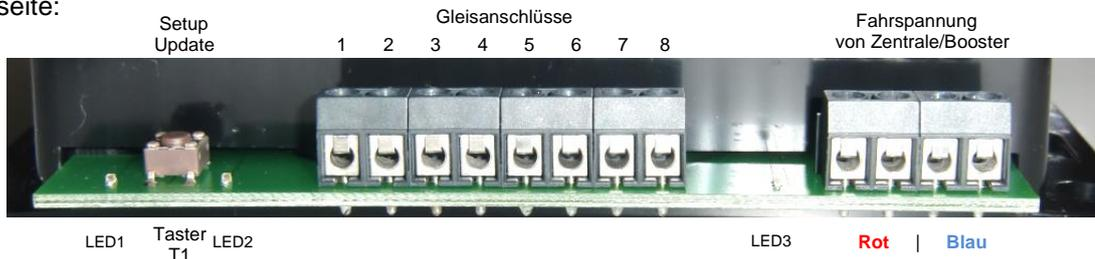
Diese acht Gleisanschlüsse stellen die notwendigen Anschlüsse für die zu überwachenden Blockstrecken bereit. Siehe Anschluss-Beispiel auf **Seite 8**.
