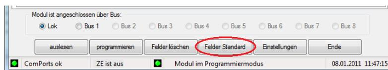
Über '**Felder Standard**' werden die Standard-Werte auf der Bildschirmmaske für Modul-SX-Adresse (90), Rückmelde-SX-Adresse (91), IR-SX-Adresse (0), Richtungsänderungsversatz (16) und Drehgeschwindigkeit (32) eingetragen. Dies hat noch keinerlei Einfluss auf das Drehscheiben-Modul.
