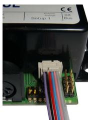
Anschluss des externen Bedien-Moduls am Drehscheiben-Modul.
