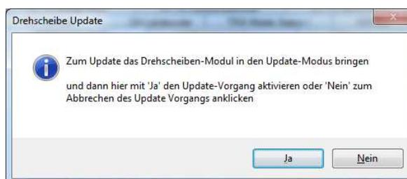
Dazu muss nun die **'T1'** Taste für ca. drei Sekunden gedrückt werden. Während des Drückens der Taste blitzt die LED1 fünf Mal auf und blinkt dann schell (ca. 6x an und 6x aus pro Sekunde). Dadurch zeigt das Drehscheiben-Modul an, dass es sich im Update-Modus befindet.
