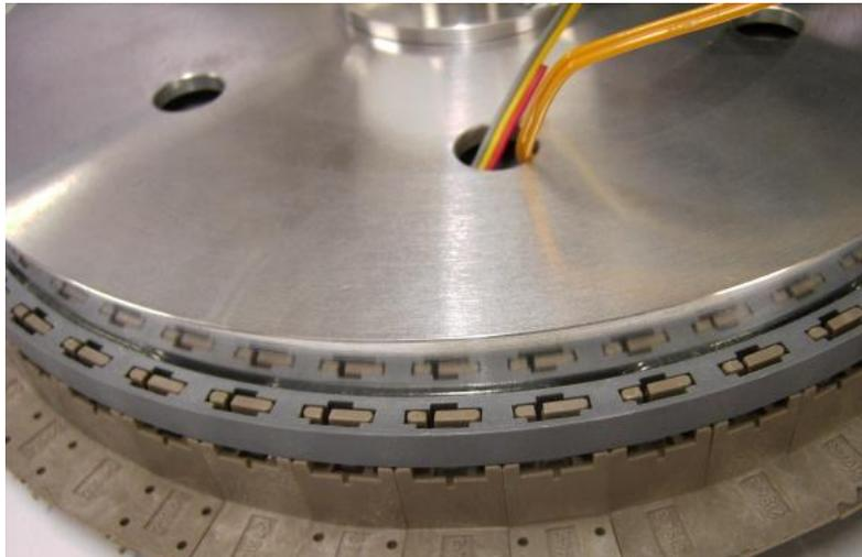
Dann wird der MTTM-Drehscheiben-Antrieb (Alu-Antriebsteller) eingesetzt. Zentriert wird das ganze über die Antriebswelle. Dabei muss überprüft werden, dass die Bühne sich ohne zu haken leicht drehen lässt. Nun muss der Kleber gut durchtrocknen.
