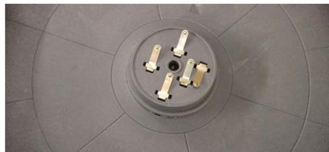
In der Drehscheiben-Grube muss nun die Achse in der die Bühne vorher saß entfernt werden. Hierbei sollte mit größter Sorgfalt vorgegangen werden, damit die Schleifkontakte nicht beschädigt werden!
