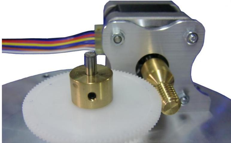
Auf die Antriebswelle kommen nun die 4mm Unterlegscheibe und dann das Antriebszahnrad. Das Zahnrad wird mit der Antriebswelle über die Madenschraube befestigt. Beachtet werden muss hier, dass die Schraube auf die abgeflachte Stelle in der Antriebswelle trifft und dass die Antriebswelle des Motors mittig zum Zahnrad steht!
