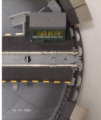
Zuerst werden fünf Schienenanschlüsse bzw. Blindstutzen auf beiden Seiten des Bühnenkranzes entfernt.
