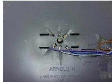
Zuerst wird auf der Grubenunterseite das Halteblech aus Kupfer entfernt. Dadurch kann die Bühne nach oben abgezogen werden.
