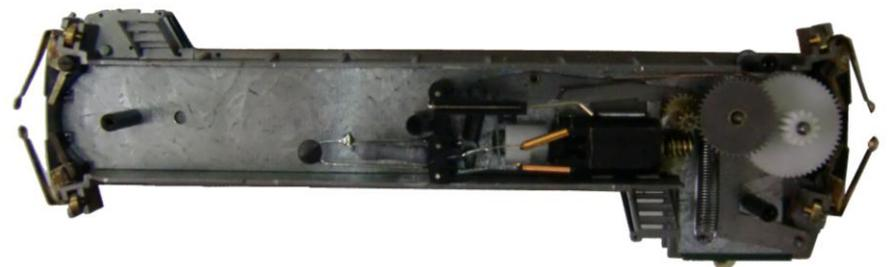
Der Motor, die drei Zahnräder, die beiden Drosselspulen und der Widerstand mit Kondensator, die Feder und die Verriegelung müssen nun entfernt werden.
