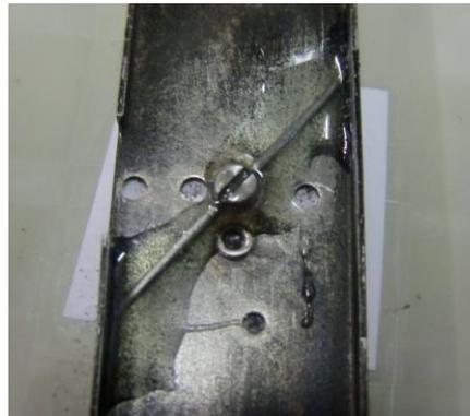
**Hinweis:** Dies ist ein extrem wichtiger Vorgang! Wenn hier durch Unachtsamkeit zwischen der 4mm Drehachse und der Drehscheiben-Bühne Spiel entsteht, verschlechtert dies die Positionierungsgenauigkeit des Drehscheiben-Antriebs.
