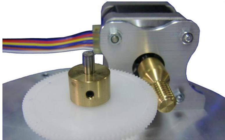
Auf die Antriebswelle kommen nun die 4mm Unterlegscheibe und dann das Antriebszahnrad. Das Zahnrad wird mit der Antriebswelle über die Madenschraube befestigt. Beachtet werden muss hier, dass die Schraube auf die abgeflachte Stelle in der Antriebswelle trifft und dass die Antriebswelle des Motors mittig zum Zahnrad steht!
