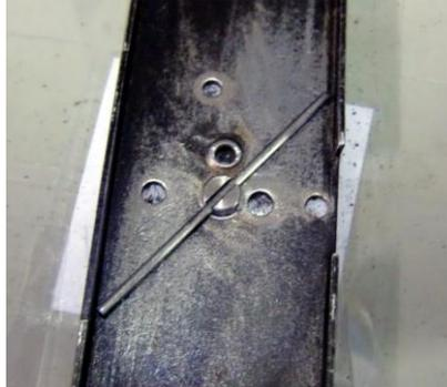
Mit einem Zweikomponenten-Kleber wird der Bodendeckel mit der 4mm Drehachse verklebt. Hier sollte sehr vorsichtig gearbeitet werden, damit kein Klebstoff an Stellen kommt, wo er nicht gewünscht ist. Bevor allerdings geklebt wird, müssen alle Stellen von Staub und Fett gereinigt werden. Der Klebstoff muss nun komplett trocknen.
