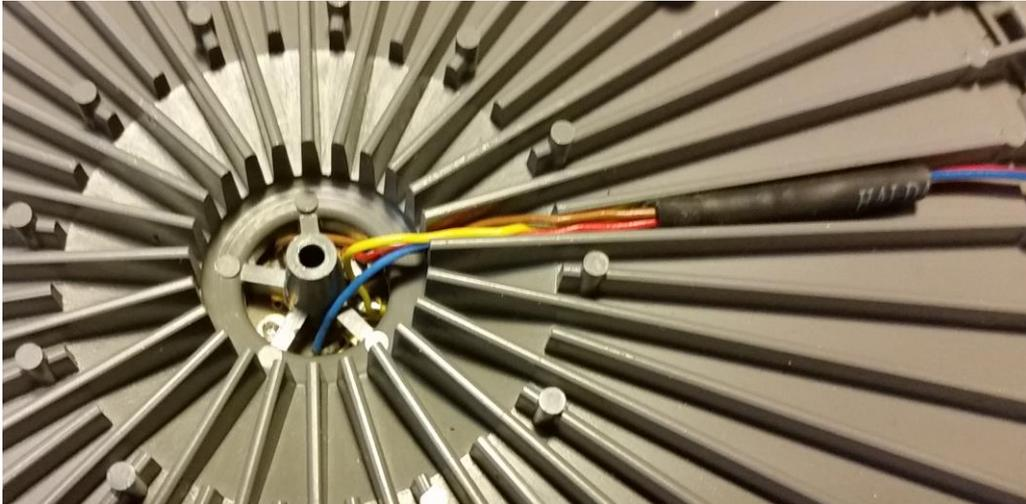
Damit die Bühne, die ja nun nicht von außen sondern von innen gedreht wird, ruckfrei fährt, müssen die Schleifkontakte an den Außenseiten der Schienen entfernt werden (auf beiden Seiten).
