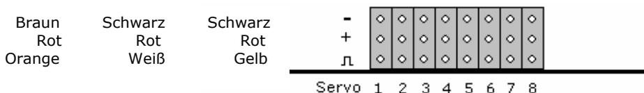
Sobald das Modul von der SELECTRIX Zentrale mit Strom und Datensignalen versorgt wird – bzw. die Versorgungsspannung für Analogbetrieb bekommt – fängt es an zu arbeiten. Liegt auch die Servo-Betriebsspannung an, blinkt die LED im schnellen Rhythmus – ca. 6 x in der Sekunde. Fehlt die Servo-Betriebsspannung so blinkt die LED im Sekundenrhythmus.
