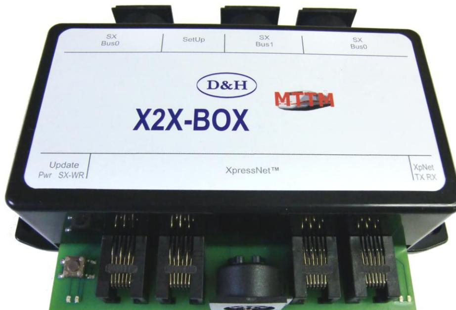
Diese neu entwickelte X2X-Box ermöglicht es, vorhandene Fahr- oder Stellregler wie die Roco Maus, das Roco RouteControl oder den Lenz LH90/LH100 an unsere Future-Central-Control (FCC) anzuschließen. Dazu bietet die X2X-Box auf der einen Seite Anschlüsse für XpressNet™ Geräte und auf der anderen Seite Anschlüsse für zwei SelectRIX Busse.
